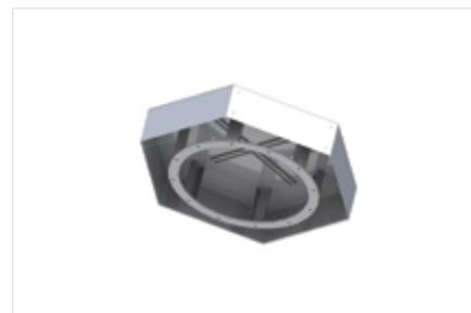
Схема 68. Защитная крыша от осадков
