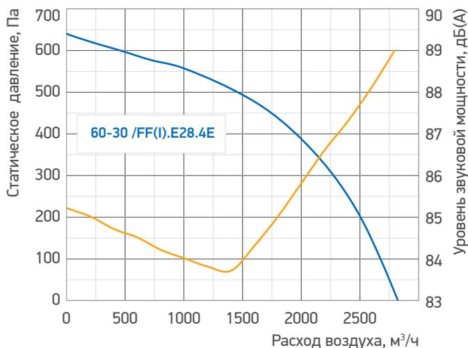
Гр. 12. Аэродинамические и звуковые характеристики вентиляторов /FF(I).E28.4D
