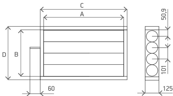
Схема 24. Габаритные и присоединительные размеры воздушных клапанов /VU.1 и /VN.1
