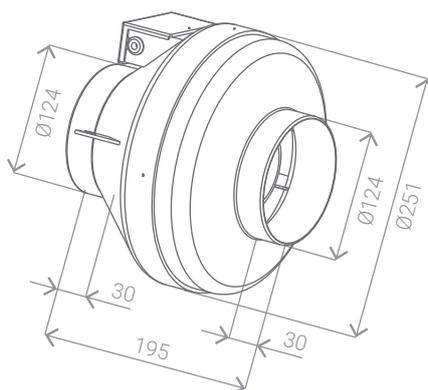
Схема 29. Вентилятор 160 /FBP.E22.2E
