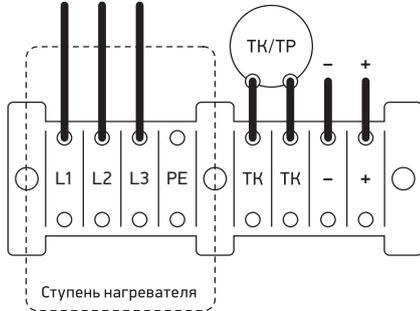
Схема 13. Схема подключения электронагревателя 1 ф~220В
