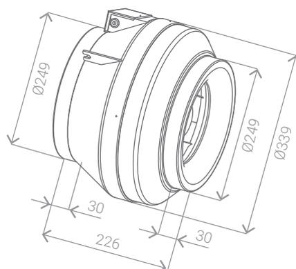
Схема 32. Вентилятор 315 /FBP.E28.2E
