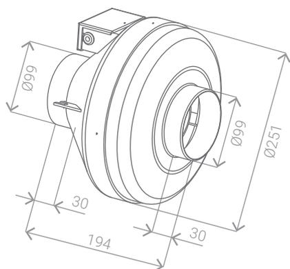
Схема 28. Вентилятор 125 /FBP.E19.2E
