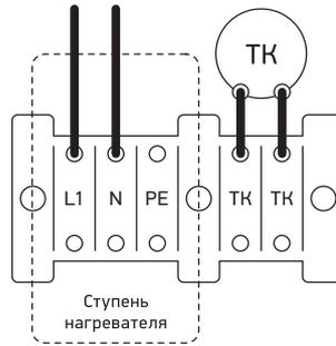
Схема 14. Схема подключения электронагревателя 3 ф~380В
