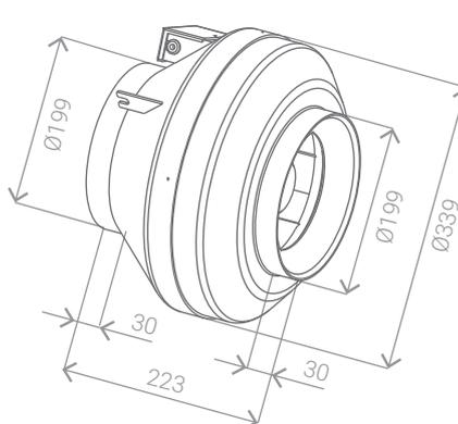
Схема 31. Вентилятор 250 /FBP.E25.2E
