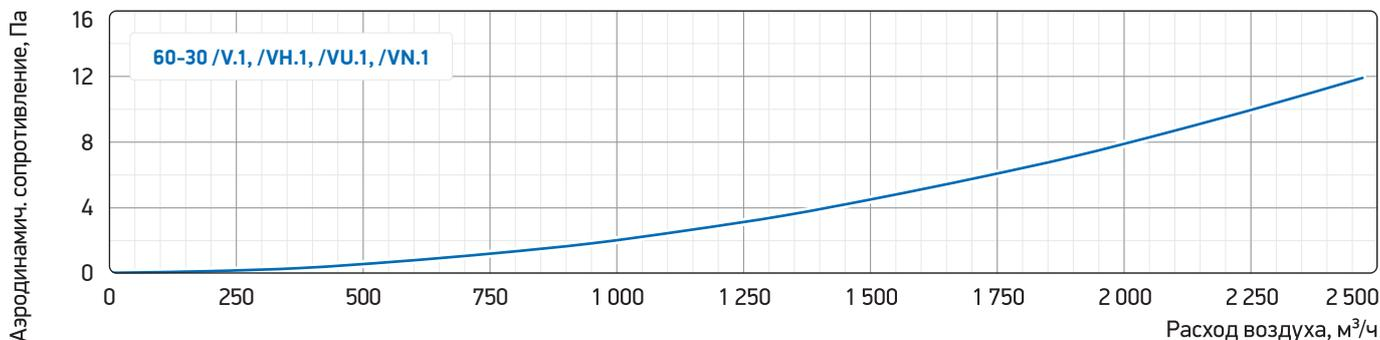
Гр. 37. Аэродинамические характеристики воздушных клапанов 60-35 /V\_1
