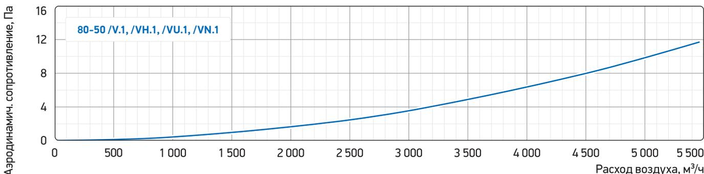
Гр. 40. Аэродинамические характеристики воздушных клапанов 90-50 /V\_1
