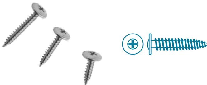
Саморез с пресс-шайбой острый изготавливается из оцинкованной стали и применяется для крепления листового металла к металлическим профилям толщиной до 0,9 мм
