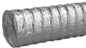
Гибкие неизолированные воздуховоды серии NV изготавливаются из многослойной металлизированной пленки, ламинированной полимерной лентой, со спиральным каркасом из стальной проволоки между слоями.
