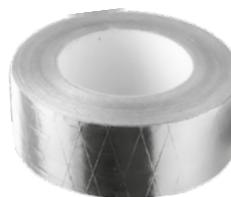
Скотч алюминиевый армированный изготовлен из алюминиевой фольги на бумажной основе, армированной стекловолокном, с клеящим составом и бумажной подложки. Скотч алюминиевый армированный предназначен для герметизации систем вентиляции, при монтаже теплоизоляции для труб отопления.
