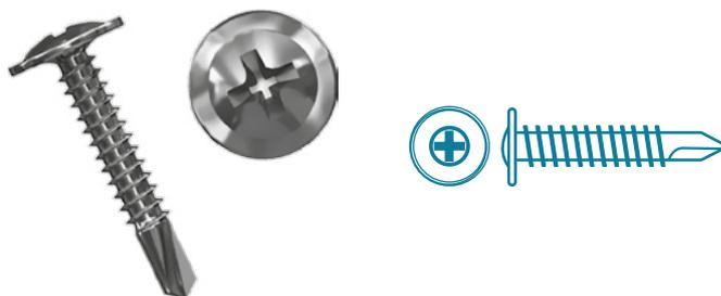
Саморез с пресс-шайбой (сверло) изготавливается из оцинкованной стали и применяется для крепления листового металла к металлическим профилям толщиной до 2,0 мм
