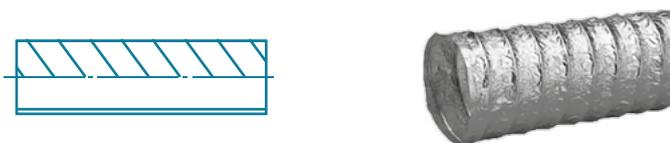
Гибкие неизолированные воздуховоды серии NVA изготавливаются из алюминиевой фольги, ламинированной полимерной лентой, со спиральным каркасом из стальной проволоки между слоями.
