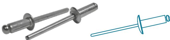
Заклепка вытяжная комбинированная состоит из металлического оцинкованного стержня и алюминиевого тела заклепки. Используется для создания неразъемных соединений тонколистовых металлов и конструкций из стали.
