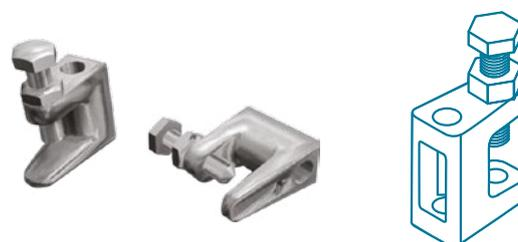
Струбцина монтажная изготавливается из чугуна методом литья и укомплектована стальным оцинкованным болтом, при помощи которого она надежно крепится к несущим конструкциям. Она предназначена для монтажа воздуховодов и других инженерных систем.
