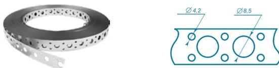
Лента перфорированная производится методом штамповки из оцинкованной или нержавеющей стали и используется при монтаже воздуховодов как круглых, так и прямоугольных. Поставляется в рулонах намоткой 25 м.п. или 50 м.п.
