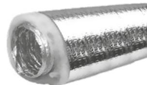
Гибкие теплоизолированные, шумопоглощающие воздуховоды серии SONONV изготавливаются из внутреннего перфорированного воздуховода серии NVA, слоя теплоизоляции (нетканое полиэфирное волокно), наружного чехла, изготовленного из металлизированной пленки.
